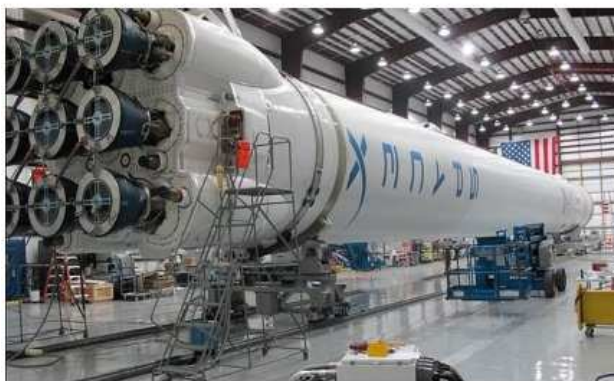
Falcon 9 con i suoi 9 motori Merlin
