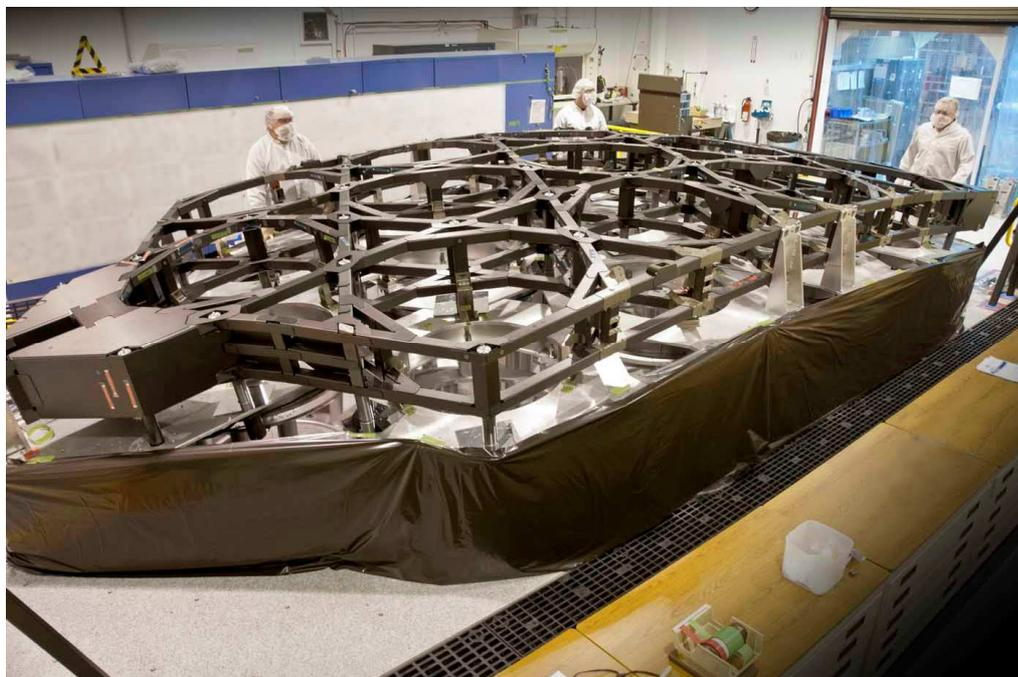
Gli ingegneri della Northrop Grumman Corporation e della ATK hanno completato la costruzione della prima di tre sezioni del *backplane* di JWST, il James Webb Space Telescope, il telescopio spaziale della NASA destinato a raccogliere il
