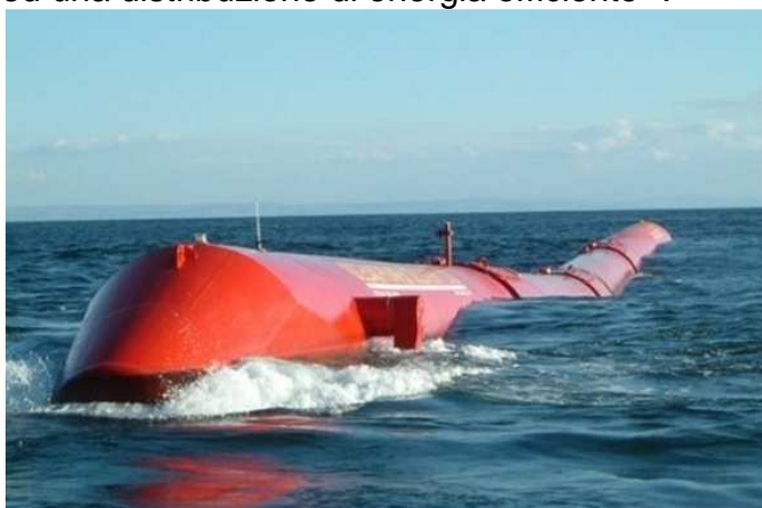
Il Pelamis (Portogallo) per lo sfruttamento delle onde.
