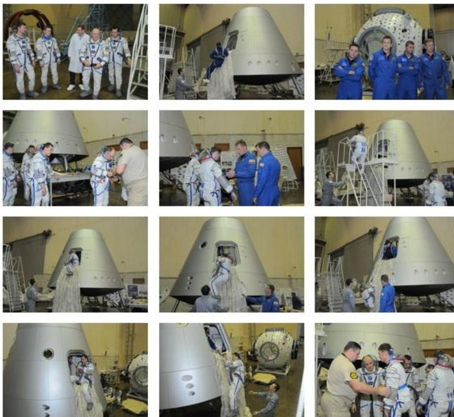
Trasporto Abitato Avanzato di Nuova Generazione (**PTK NP - Pilotiruemyi Transportny Korabl Novogo Pokoleniya**) è stata eseguita una serie di test presso il centro S.P. Korolev Rocket e Space Corporation Energia per testare le attività degli equipaggi durante le fasi di ingresso e di uscita in casi di emergenza dal compartimento di comando del veicolo di rientro.
