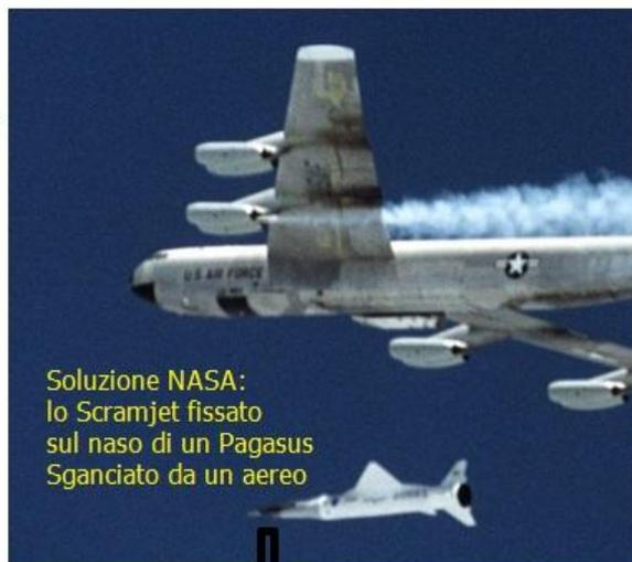
Soluzione NASA: lo Scramjet fissato sul naso di un Pegasus Sganciato da un aereo
