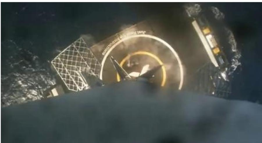
Due minuti e mezzo dopo, il primo stadio del Falcon 9 si è sganciato ed è tornato verso il suolo, virando attraverso l'alta atmosfera rarefatta **utilizzando le alette aerodinamiche e periodiche accensioni dei propulsori**, portandosi fino ad un atterraggio propulsivo sulla chiatta (la nave drone), galleggiante
