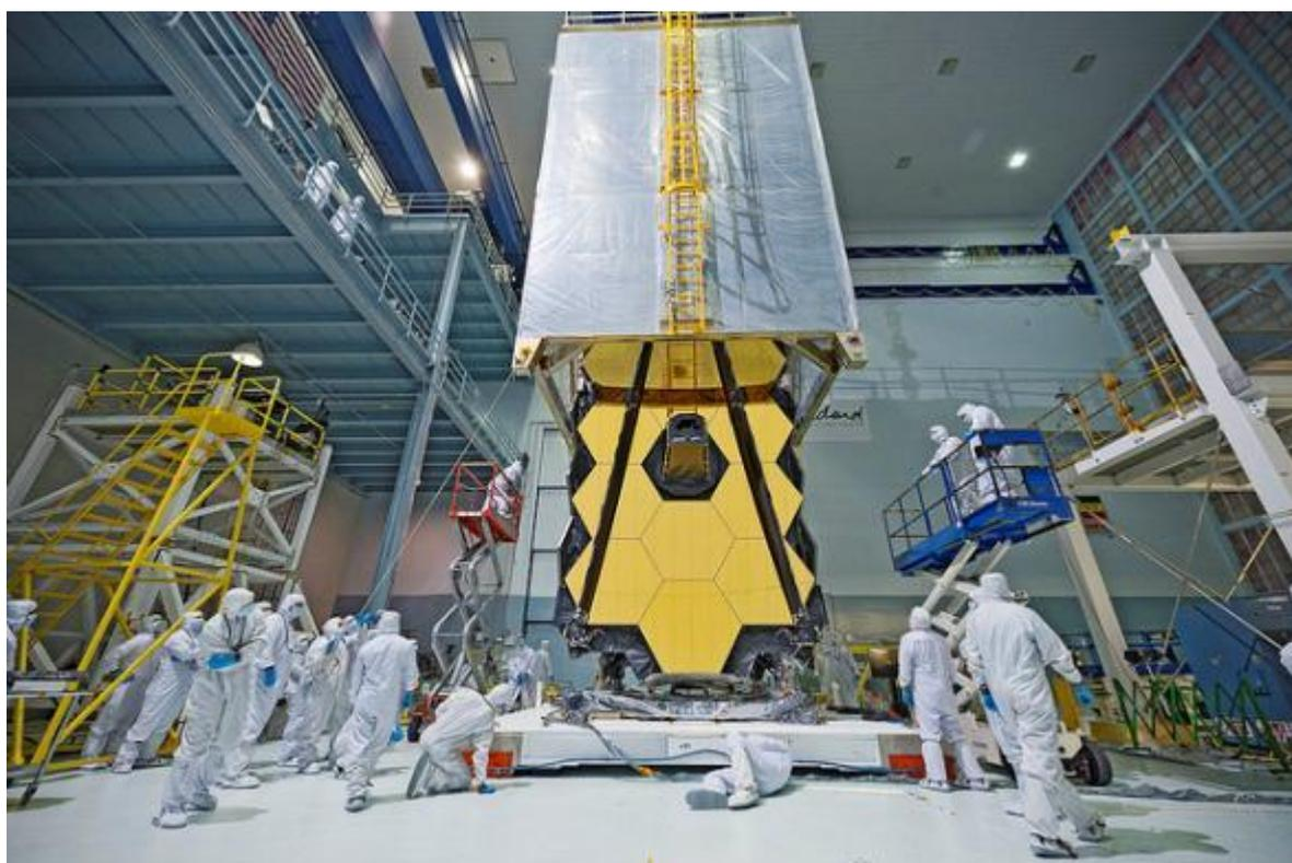
***Il JWST viene preparato per i test di vibrazione nel novembre 2016. Credit NASA.***
