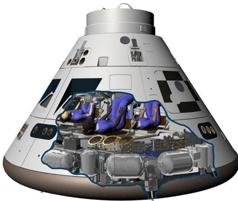
**Il modulo dell'equipaggio ORION può ospitare quattro persone per fino a tre settimane in un volume equivalente di un minivan. (Immagine di credito: NASA)**
