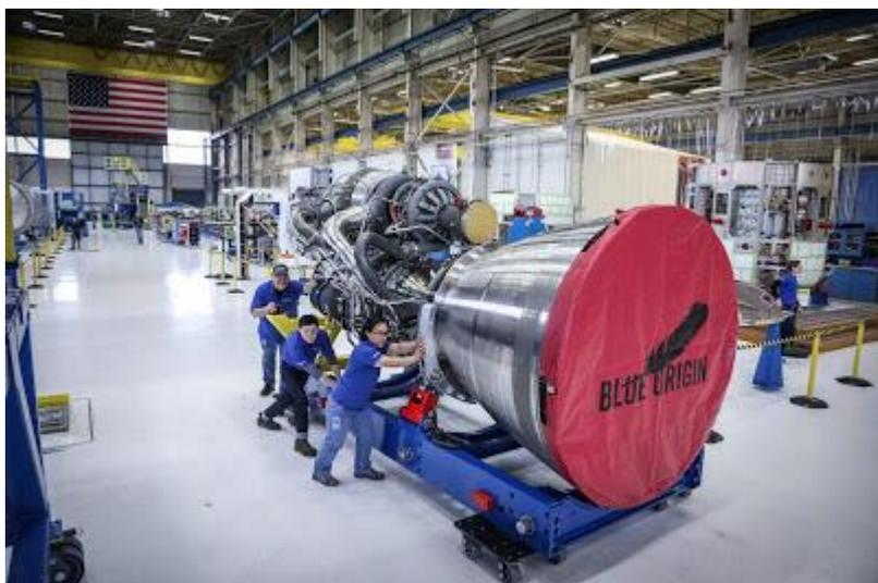
Il nuovo razzo New Glenn sarà 82 metri di altezza, con il 1° stadio composto da 7 motori BE-4, a propellente liquido che verranno **alimentati da gas naturale liquefatto (metano) ed ossigeno liquido.**
