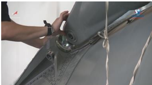
La punta di un booster della Soyuz MS-10 viene inserita nell'apposito alloggiamento sul core, durante l'integrazione a Baikonur. Credit: Roscosmos.
