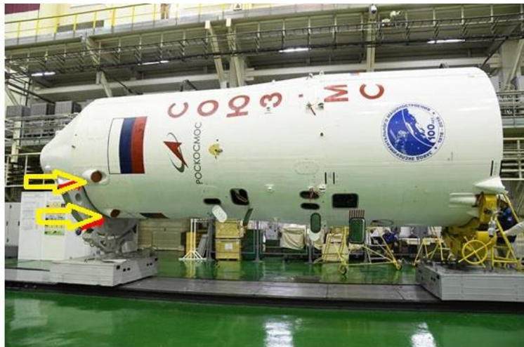
Il fairing della Soyuz MS-10. Le frecce evidenziano la posizione di due dei motori di emergenza. Credit: Roscosmos
