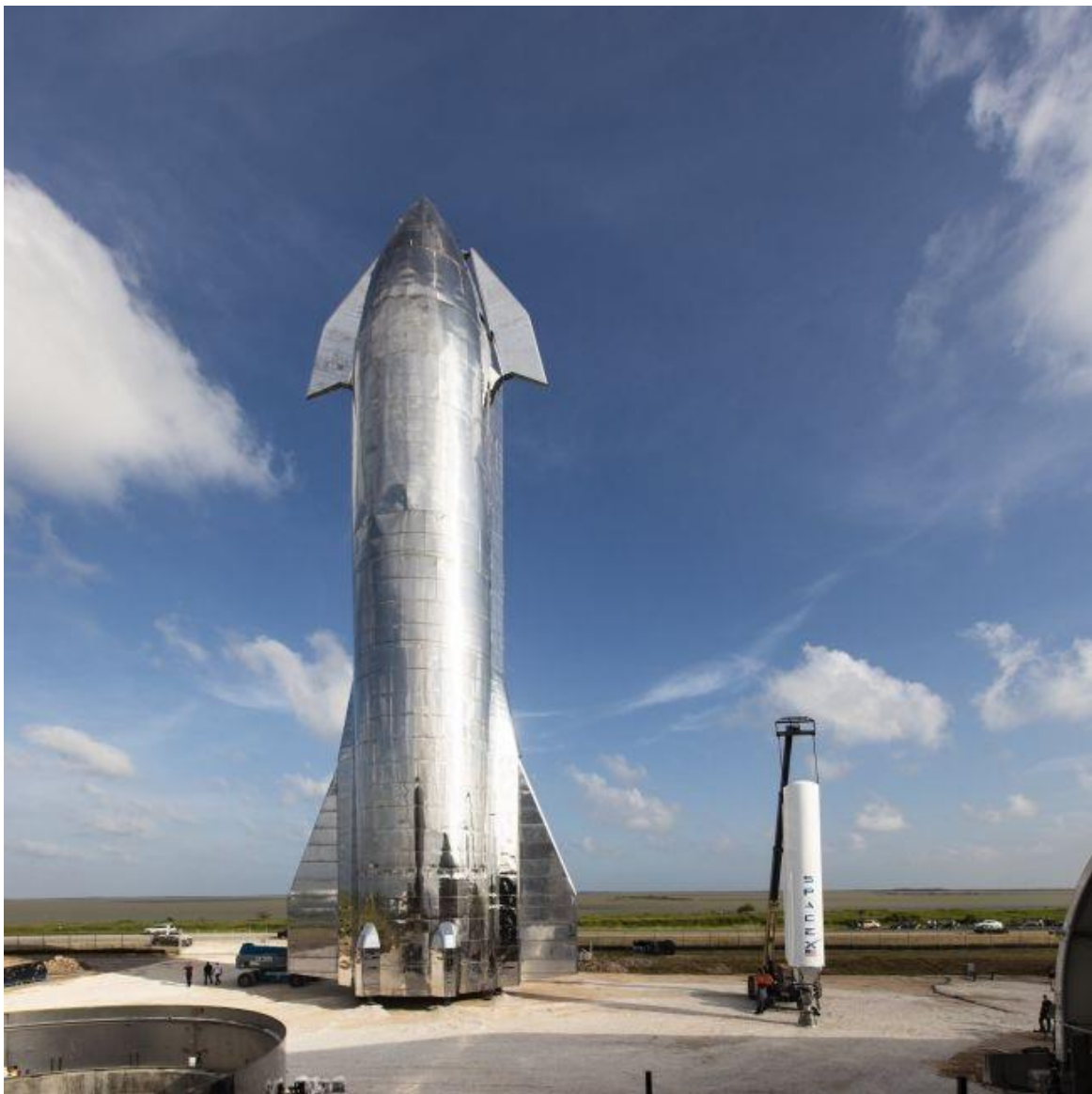
Il prototipo di SpaceX Starship Mk1 (a sinistra) si trova accanto a uno dei primi stadi del razzo Falcon 1 nel sito del Texas meridionale dell'azienda. (Credito immagine: SpaceX via Twitter)
