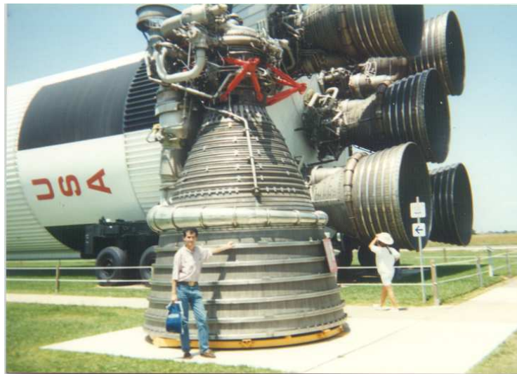
I 5 propulsori F-1 del primo stadio del Saturn V.
