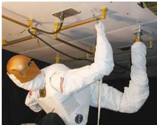
**Figura 6: Robonaut in configurazione "zero gravity"**
