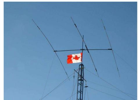
Alcuni esempi di antenne Yagi
