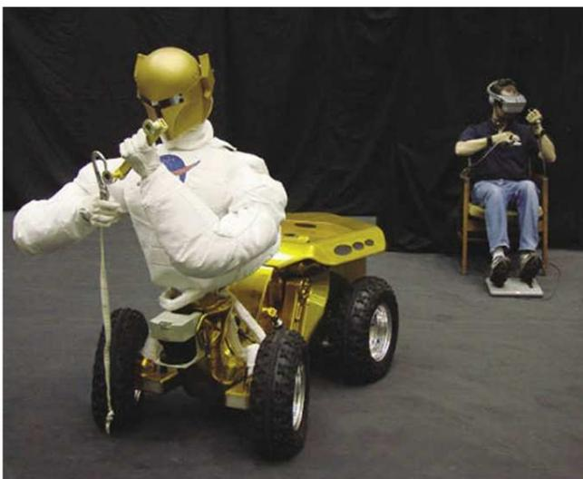
**Figura 5: Robonaut, in configurazione "mobility"**
