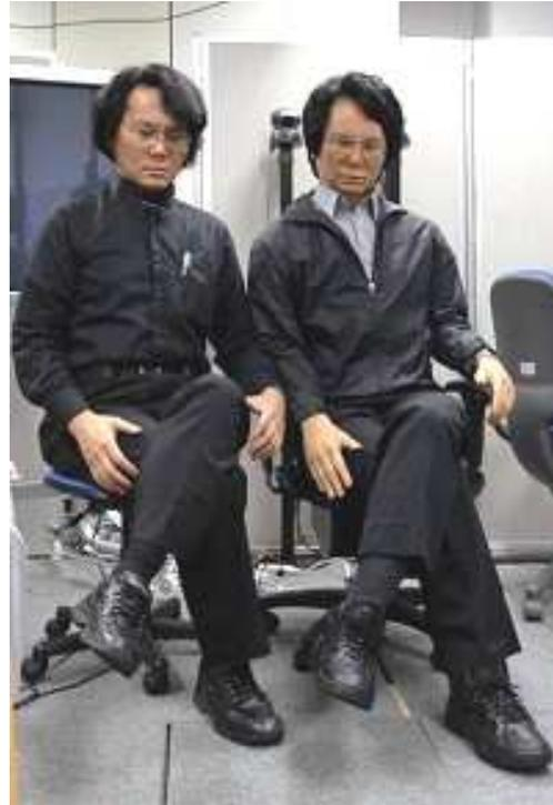
**Figura 4: Geminoid (a destra), replica robotizzata del dr. Hiroshi Ishiguro (fonte: <http://www.is.sys.es.osaka-u.ac.jp/research/0011/index.en.html>)**
