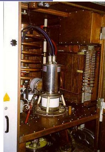
[Ricetrasmittitore a valvole No 58 Mk 1 del 1943;](#) [Valvola finale Thomson da 100 Kw](#)
