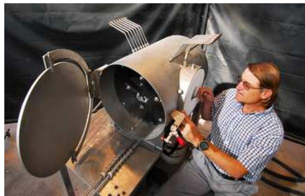
*Primo test per il prototipo di CR5 dei Sandia Lab: il sistema è in grado di sottrarre anidride carbonica dall'atmosfera. Ma serviranno almeno 15 anni per migliorarne l'efficienza*
