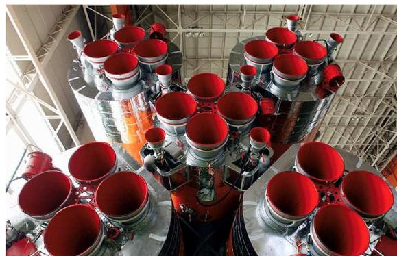
La propulsione del R-7 e' merito dell'odiato Glushko: il **RD-107** (un'evoluzione del motore RD-110 del razzo R-5) con una singola turbo pompa che alimenta simultaneamente con propellente (kerosene) e comburente (ossigeno liquido) quattro camere di combustione.
