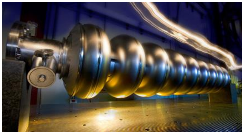
SRF cavities: la tecnologia per accelerare ad alta intensità fasci di particelle.
