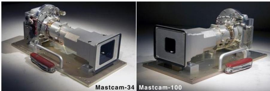
Le 2 "Mast Camera" o "[Mastcam](#)" di Mars Science Laboratory riprenderanno il terreno marziano con scatti a colori, ad alta e bassa risoluzione, e video (10 fps) ad alta definizione. Sono dotate di filtri monocromatici multipli intercambiabili (con un meccanismo a rotazione), adatti ad analizzare l'assorbimento della luce nelle diverse porzioni dello spettro elettromagnetico, nonché di una memoria abbastanza capiente da immagazzinare migliaia di immagini.
