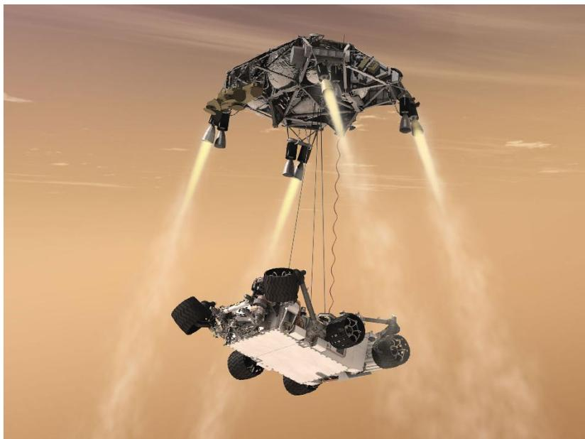
Per ottenere questi risultati sono stati utilizzati ben **76 dispositivi esplosivi** di diversi tipi (37 separation nuts, 11 cable cutters, and 3 pin-pullers, 24 di altro genere).
