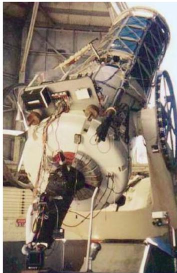
**Figura 11.** A sinistra lo strumento per fare OSETI installato al fuoco del telescopio da 1 metro di diametro al Lick Observatory (il Nickel Telescope). Credits Link Observatory.
