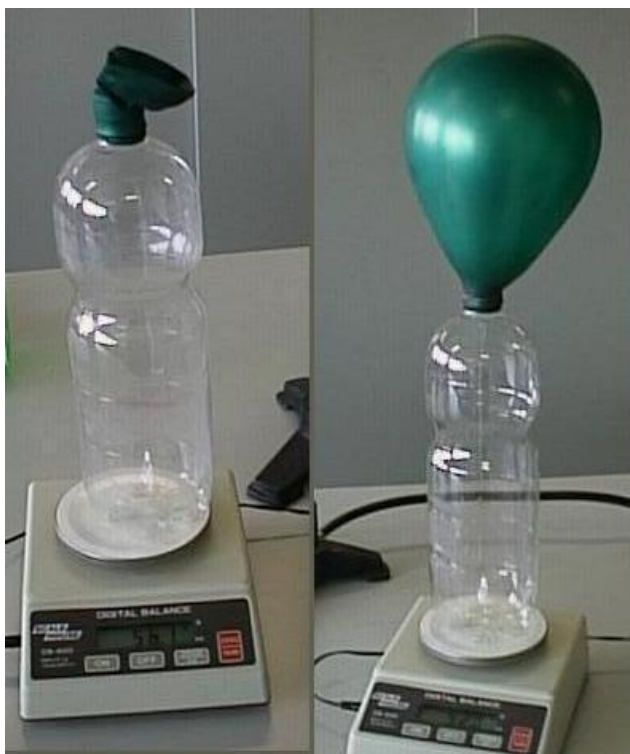
figura 1 Nella bottiglia è contenuta aria compressa. Svitando il tappo il palloncino si gonfia ed il peso totale diminuisce a causa dell'aumento della spinta di Archimede.
