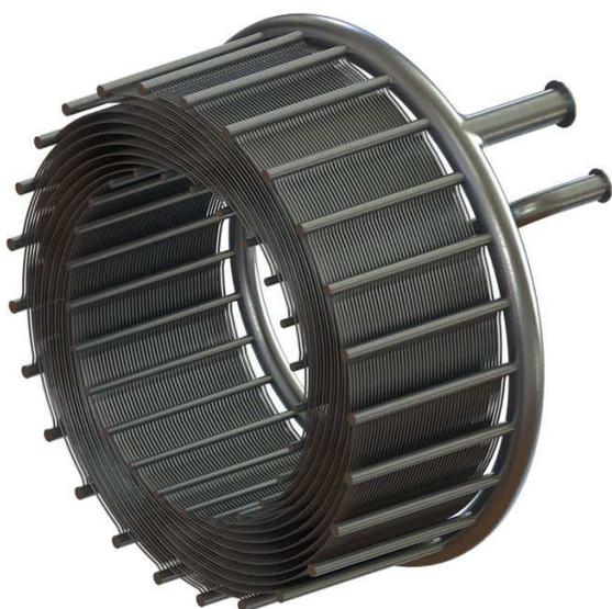
**Il pre-cooler del SABRE con i suoi chilometri di tubicini percorsi dall'elio liquido.**
