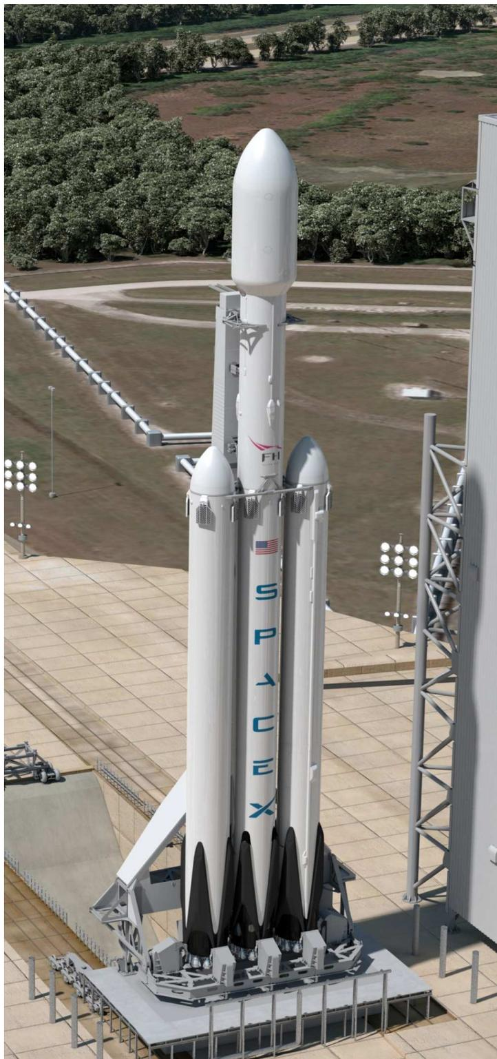
***Il Falcon 9 nella configurazione Havy. Il Falcon 9 Full thrust, attualmente in uso consiste nella sola parte centrale. Si notino i 4 piedi rientrabili (per ogni stadio) per il ritorno in verticale sulla chiatta (ne parliamo più avanti)***
