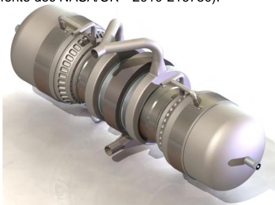
Qui sopra vediamo un convertitore Stirling utilizzato in un generatore FSP (simile al Krusty) e sotto una mezza sezione.
