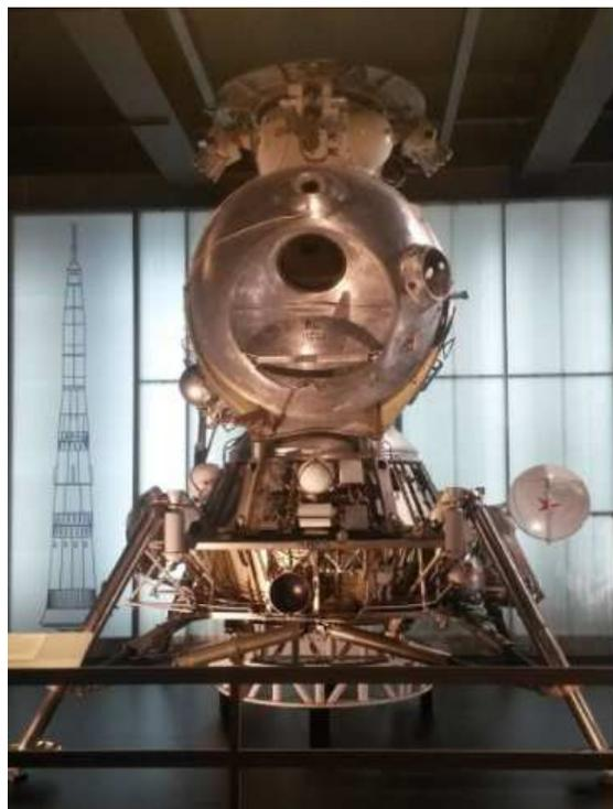
Il LK é lungo 5m e pesa 5ton (contro i 7m e 16ton del LM)
