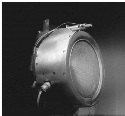
**Sopra: il motore a ioni NSTAR della sonda Deep Space Probe. (Image courtesy of NASA.)**
