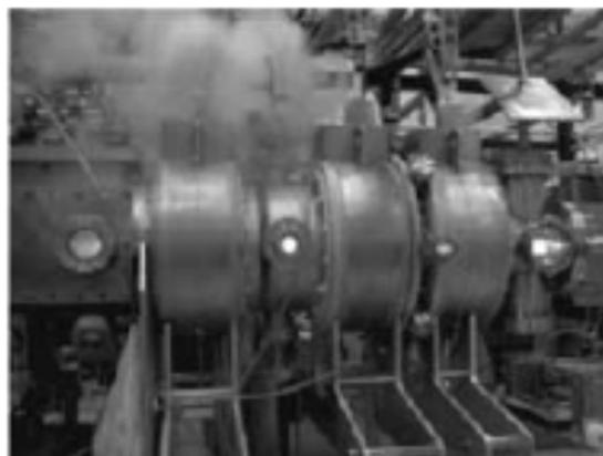
Un tipico esempio di un motore elettrotermico è quello ad impulso specifico variabile (variable specific impulse magnetoplasma rocket (**VASIMR**)) inventato dall'astronauta Franklin Chang-Diaz di cui abbiamo già parlato sulle pagine di questa rivista.
