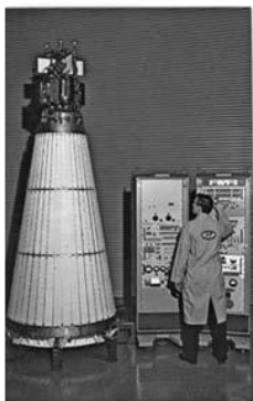
Il sistema del reattore a fissione SNAP-10A. (Immagine gentilmente concessa dal Dipartimento per l'energia degli Stati Uniti.)
