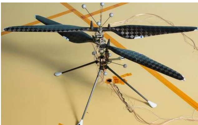
Il prototipo dimostrativo usato in precedenza per i test ingegneristici - Credits: NASA/JPL-Caltech
