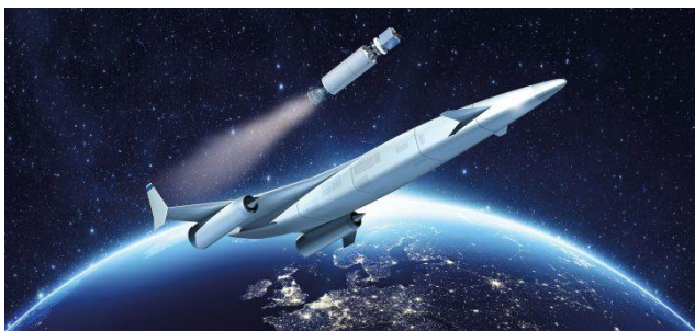
Esempio di spaziosplano TSTO (Two Stage To Orbit) equipaggiato con due propulsori SABRE.
