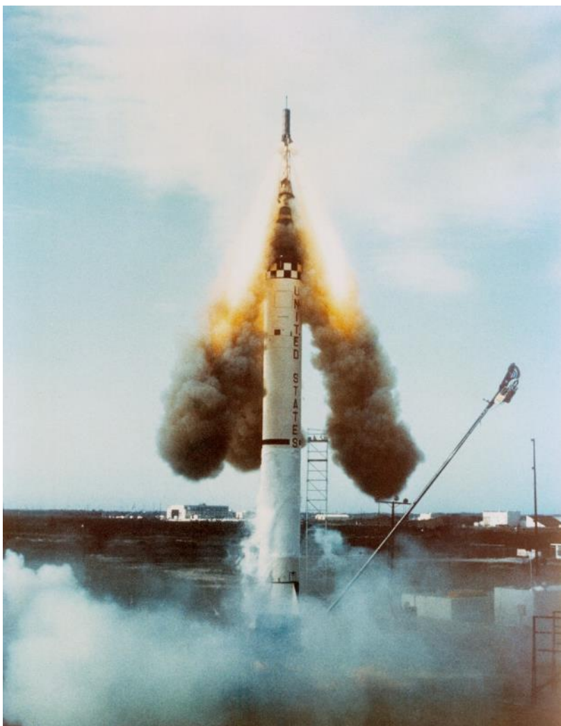
Il Sistema di fuga azionato nella missione Mercury-Redstone 1 fallita alla partenza.
