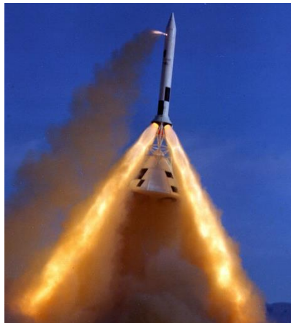
Un test del LES dell'Apollo con una capsula simulatore (boilerplate).
