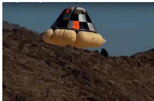
Un test di atterraggio del CT 100 con gli airbag dispiegati e dopo aver sganciato lo schermo protettivo. Credit Boeing.
