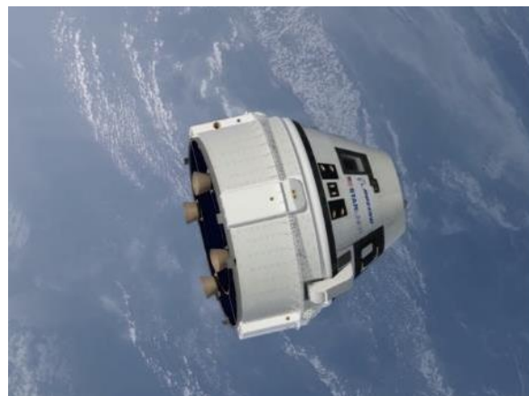
Lo Starliner CT-100 della Boeing in il volo di test ancora collegato al modulo di servizio con i razzi di spinta per il rientro e per la spinta della ISS. (Credit Boeing)
