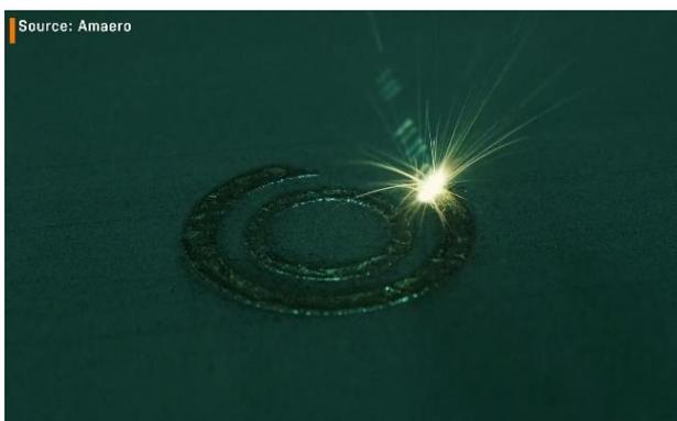
La stampa 3D consente design avanzati che possono aiutare a creare canali di raffreddamento e camere di combustione con forme che sarebbero normalmente fisicamente impossibili da produrre. Ci sono aziende come Amaero che hanno costruito aerospike fabbricati
