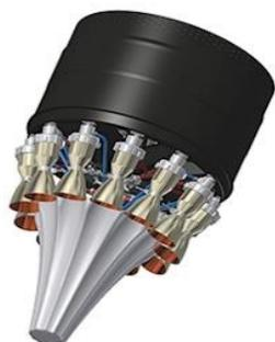
E questo concorda quando si scopre che Firefly Aerospace aveva un motore aerospike davvero promettente noto come FRE-2, che doveva essere un aerospike toroidale alimentato a metano a 12 ugelli per alimentare la sua Firefly Alpha.
